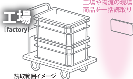
読取範囲イメージ 読み取りエリアは横方向 (X-Y 軸) への拡がりを抑える一方で、縦方向 (Z 軸) は広範囲の読み取りが可能です。
