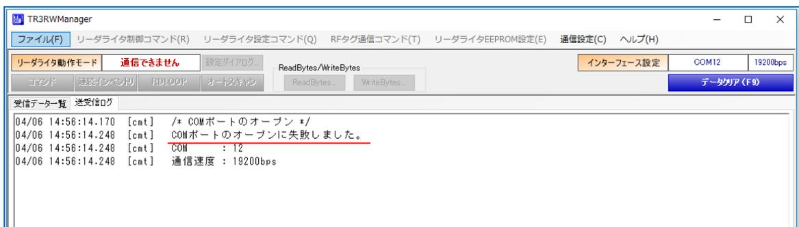
リーダライタとの通信速度が異なっていた場合は、次の画面のように表示されます。通信速度を変更して再試行するか、またはリーダライタの自動検出を行ってください。
