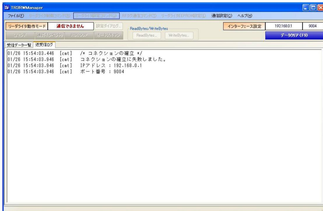
リーダライタの内部で LANI/F ボード側の通信速度とリーダライタモジュール側の通信速度の設定が異なっている場合には、次の画面のように表示されます。
