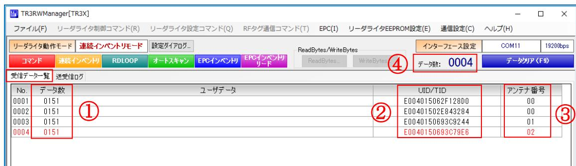
※1: アンテナ番号とは、「アンテナ自動切替」を有効にして複数のアンテナを制御するときの番号です。「00」はANT1（左端の出力端子）に接続されているアンテナを表します。
