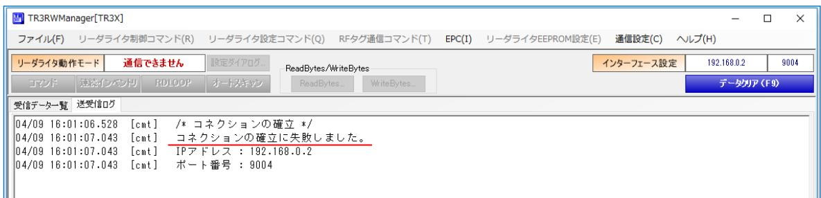
リーダライタの内部でLANインターフェースボード側の通信速度とリーダライタモジュール側の通信速度の設定が異なっている場合には、次の画面のように表示されます。
