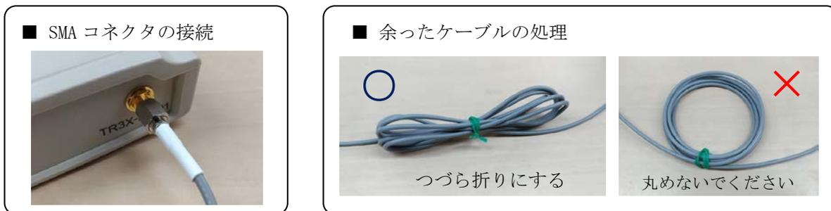
■基板アンテナへの接続方法
