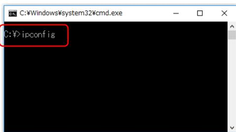
PC の IPv4 アドレスを確認します。以下の例では、PC の IPv4 アドレスは、「192.168.0.3」であることが分かります
