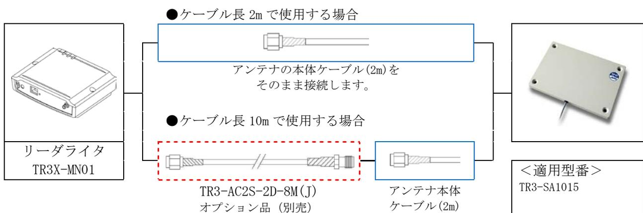
■薄型アンテナへの接続方法
