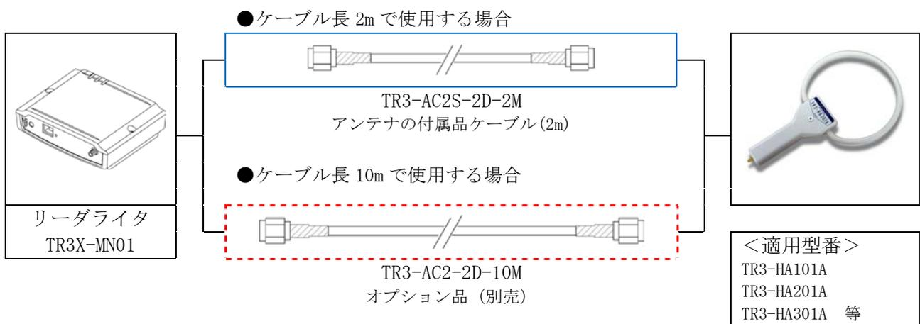
■ペン型アンテナへの接続方法
