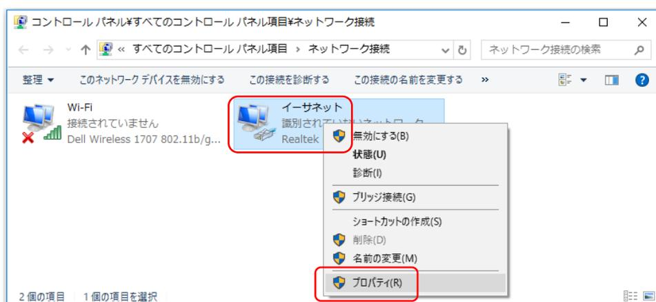
インターネットプロトコルバージョン 4(TCP/IPv4)のプロパティを開きます。
