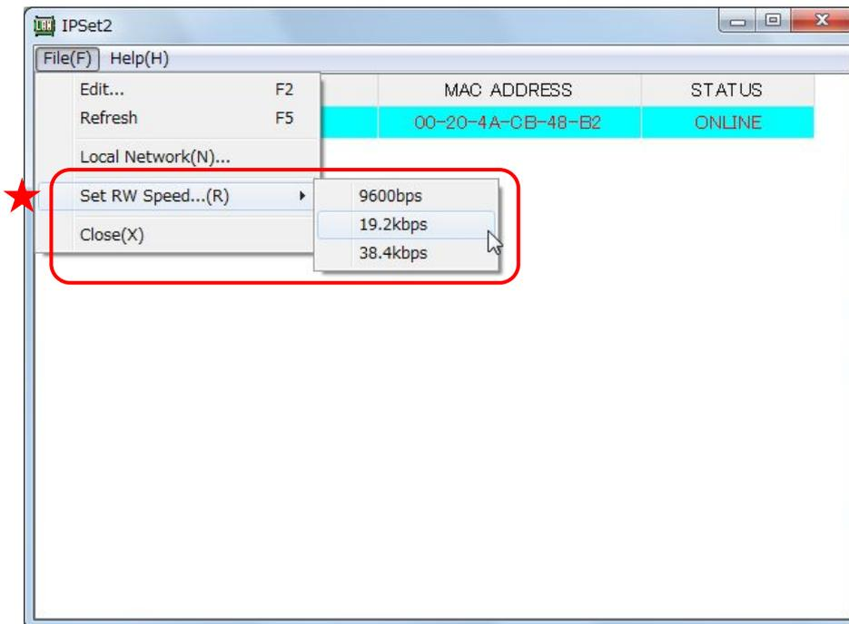
IP アドレス/ポート番号を設定し [OK] ボタンを押下します。本操作により、リーダーライタモジュール側、LAN インターフェース基板側それぞれの通信速度を同時に変更します。
