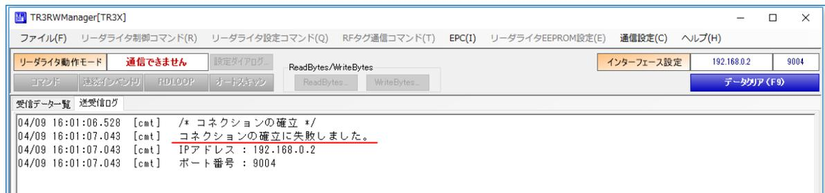
リーダライタの内部で LAN インターフェースボード側の通信速度とリーダライタモジュール側の通信速度の設定が異なっている場合には、次の画面のように表示されます。通信速度の整合を取るため、「7.2 LAN インターフェース設定の確認/変更」を参照して、通信速度の設置を変更してください。
