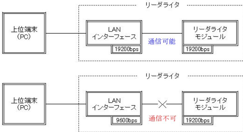
IPSet2 を起動後、File (F) メニューの[Set RW Speed (R)]を選択し、変更したい Baud Rate (9600bps、19.2kbps、38.4kbps) を選択します。
