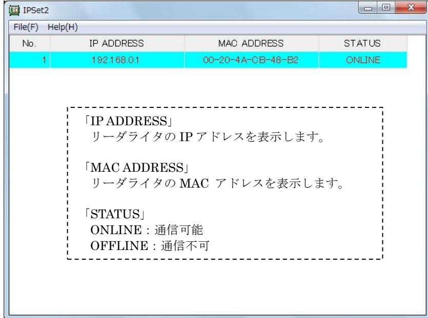
STATUS 「OFFLINE」 のリーダライタと通信する場合は、PC のネットワーク設定（IP アドレス・サブネットマスク）をリーダライタとの通信が可能な状態に設定してください。
