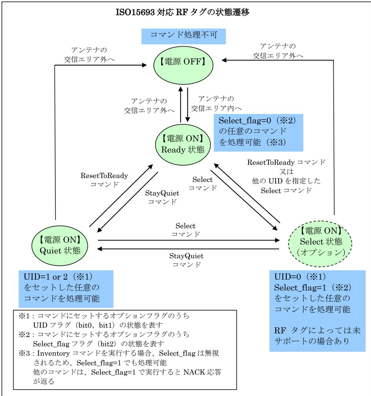
RF タグは、アンテナの交信エリアに入ると必ず Ready 状態で起動します。その後は、各種コマンド制御により、「Ready 状態」「Quiet 状態」「Select 状態」のいずれかの状態に遷移します。
