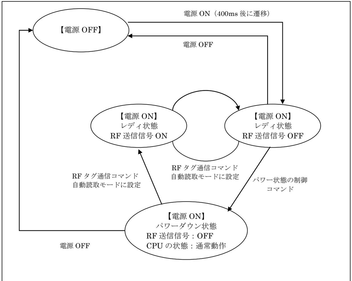
リーダライタは、電源起動後は「レディ状態 : RF 送信信号 OFF」の状態で見えます。RF 送信信号設定が「コマンド実行時以外常時 OFF」に設定されているリーダライタは、RF 送信信号の制御コマンドを受け付けません。(NACK 応答となります)
