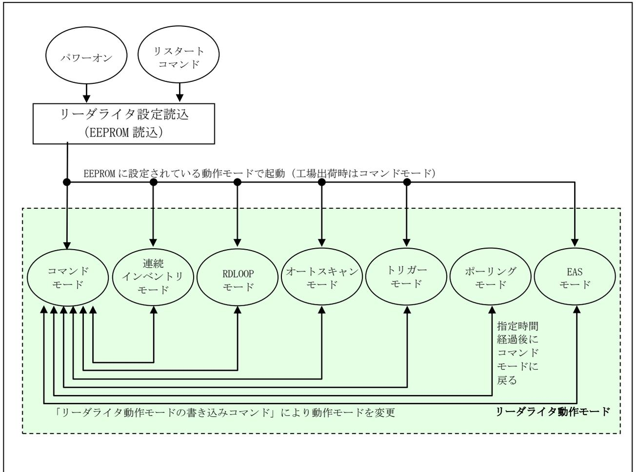
リーダーライタは、電源起動後、およびリスタートコマンド受信後にリーダーライタ内部に設定されている動作モード（EEPROM 設定）を読み取り、そのモードで起動します。工場出荷時に設定されている動作モードはコマンドモードです。
