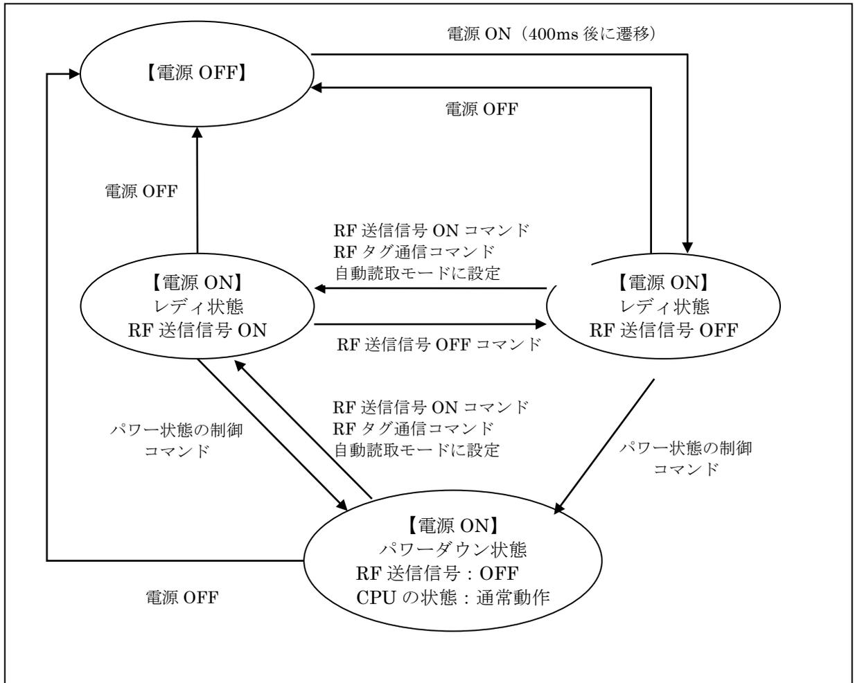
リーダライタは、電源起動後は「レディ状態 : RF 送信信号 OFF」の状態で見つかります。RF 送信信号 ON/OFF 間の遷移は、RF 送信信号の制御コマンドを使用して行います。
