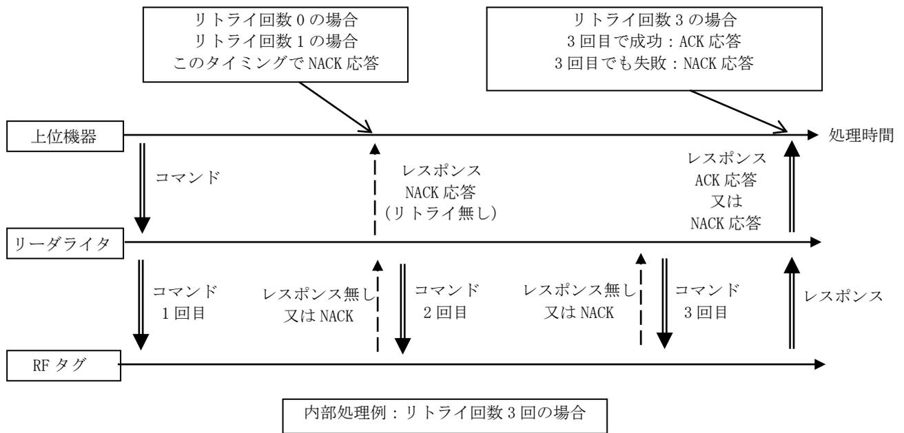
RF タグのリードコマンド、ライトコマンドを実行する際、リーダーライター内部のEEPROMにリトライ回数を設定することで、処理に失敗しても上位機器からコマンドを再送することなく、リーダーライターが自動的にリトライ処理を行います。
