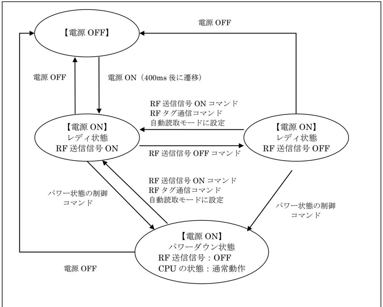
リーダライタは、電源起動後は「レディ状態：RF 送信信号 ON」の状態です。RF 送信信号 ON/OFF 間の遷移は、RF 送信信号の制御コマンドを使用して行います。
