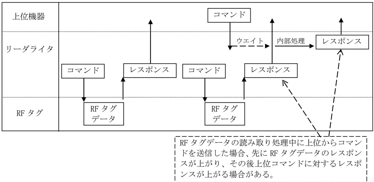
TR3 シリーズ独自の自動読み取りモード (※1) を使用する場合、上位機器からコマンドを送信することなく、RF タグのデータを読み取るたびにリーダライタから上位機器にレスポンスを返します。
