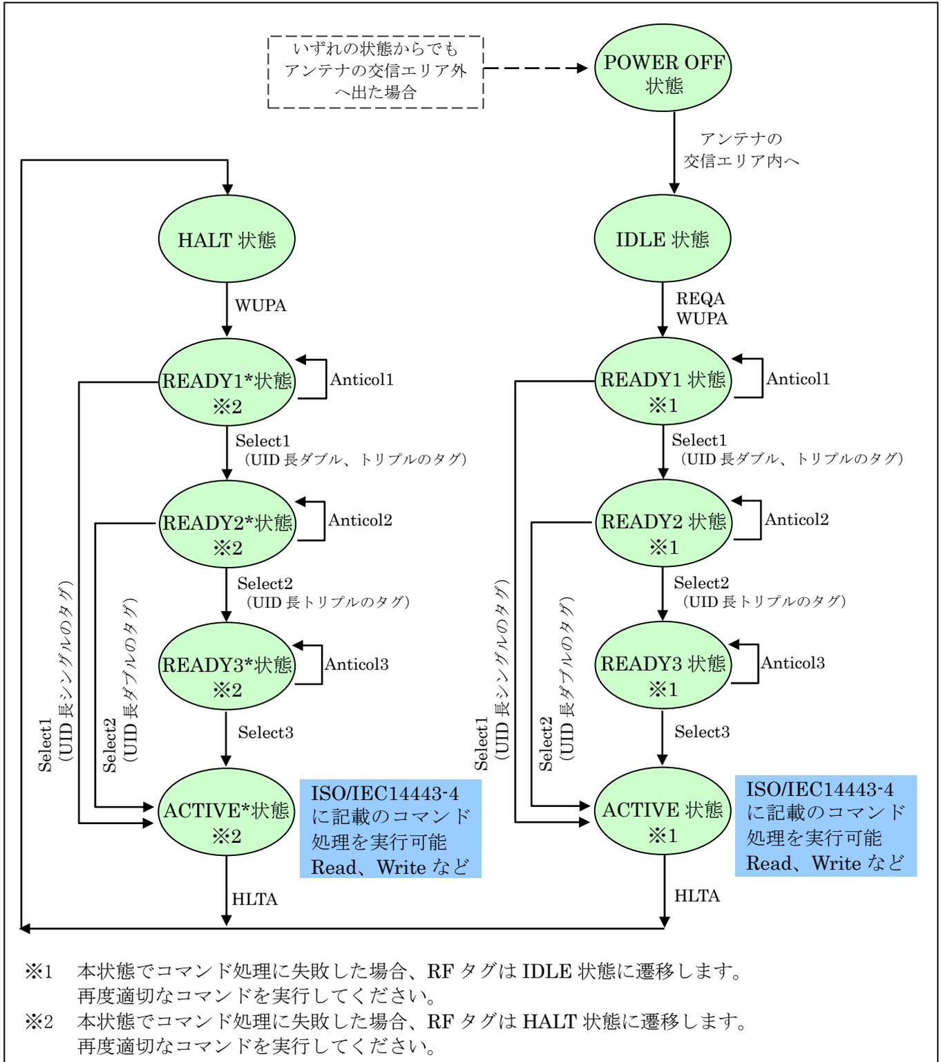
RF タグ (ISO14443TypeA) は、アンテナの交信エリアに入ると必ず IDLE 状態で起動します。その後、UID 長に応じて必要な回数 Anticol コマンドと Select コマンドを実行し、ACTIVE 状態に遷移させてから、リードやライトコマンドを実行します。
