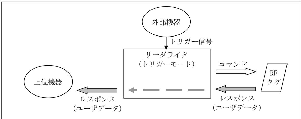
リーダライタに入力されたトリガー信号が有効な間だけ、SimpleWrite で書き込まれた TR3 シリーズ独自フォーマットのデータを、上位機器とは非同期で繰り返し読み取るモードです。本モードは、ISO15693 準拠の RF タグのみサポートしています。
