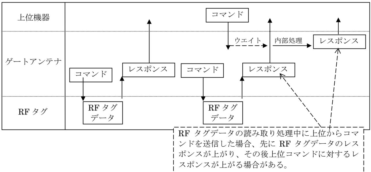
TR3 シリーズ独自の自動読み取りモード (※1) を使用する場合、上位機器からコマンドを送信することなく、RF タグのデータを読み取るたびにリーダーライタから上位機器にレスポンスを返します。
