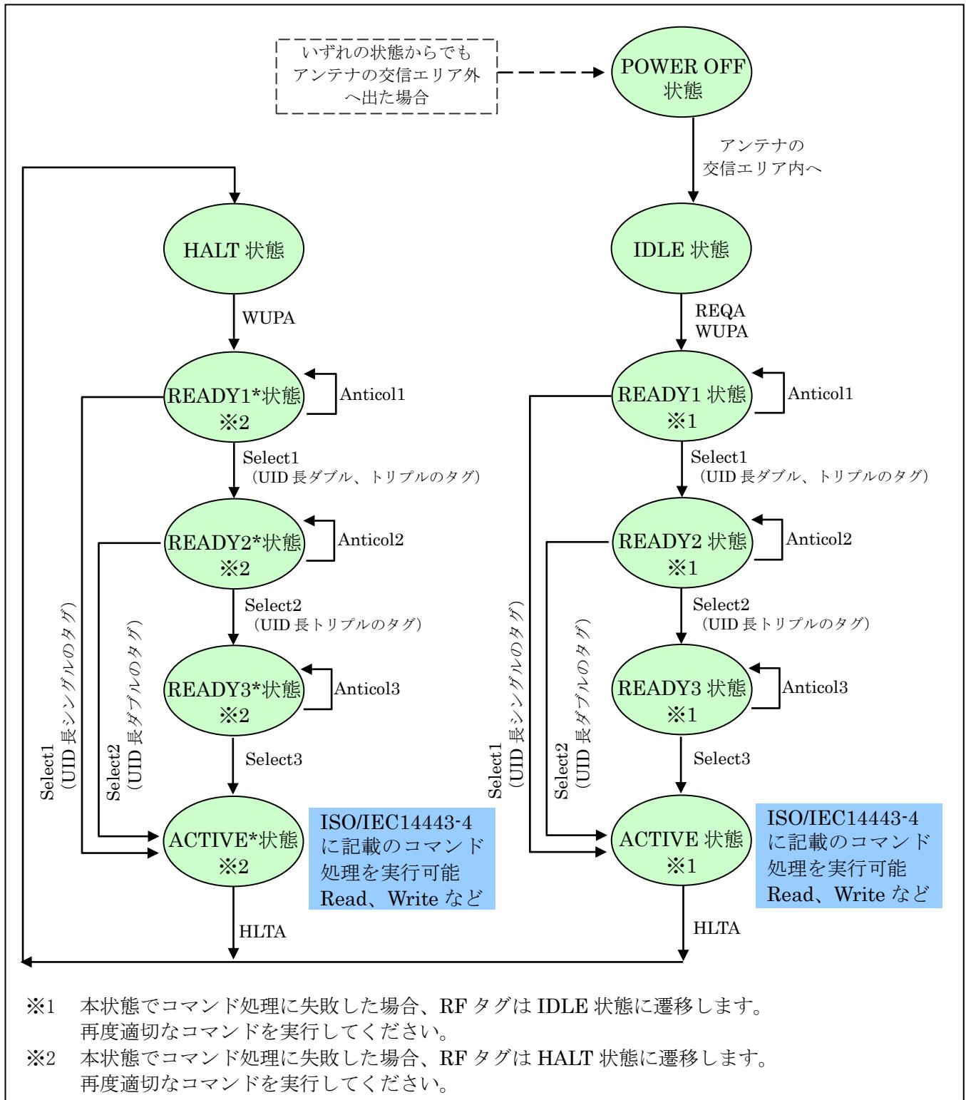
RFタグ(ISO14443TypeA)は、アンテナの交信エリアに入ると必ずIDLE状態で起動します。その後、UID長に応じて必要な回数AnticolコマンドとSelectコマンドを実行し、ACTIVE状態に遷移させてから、リードやライトコマンドを実行します。
