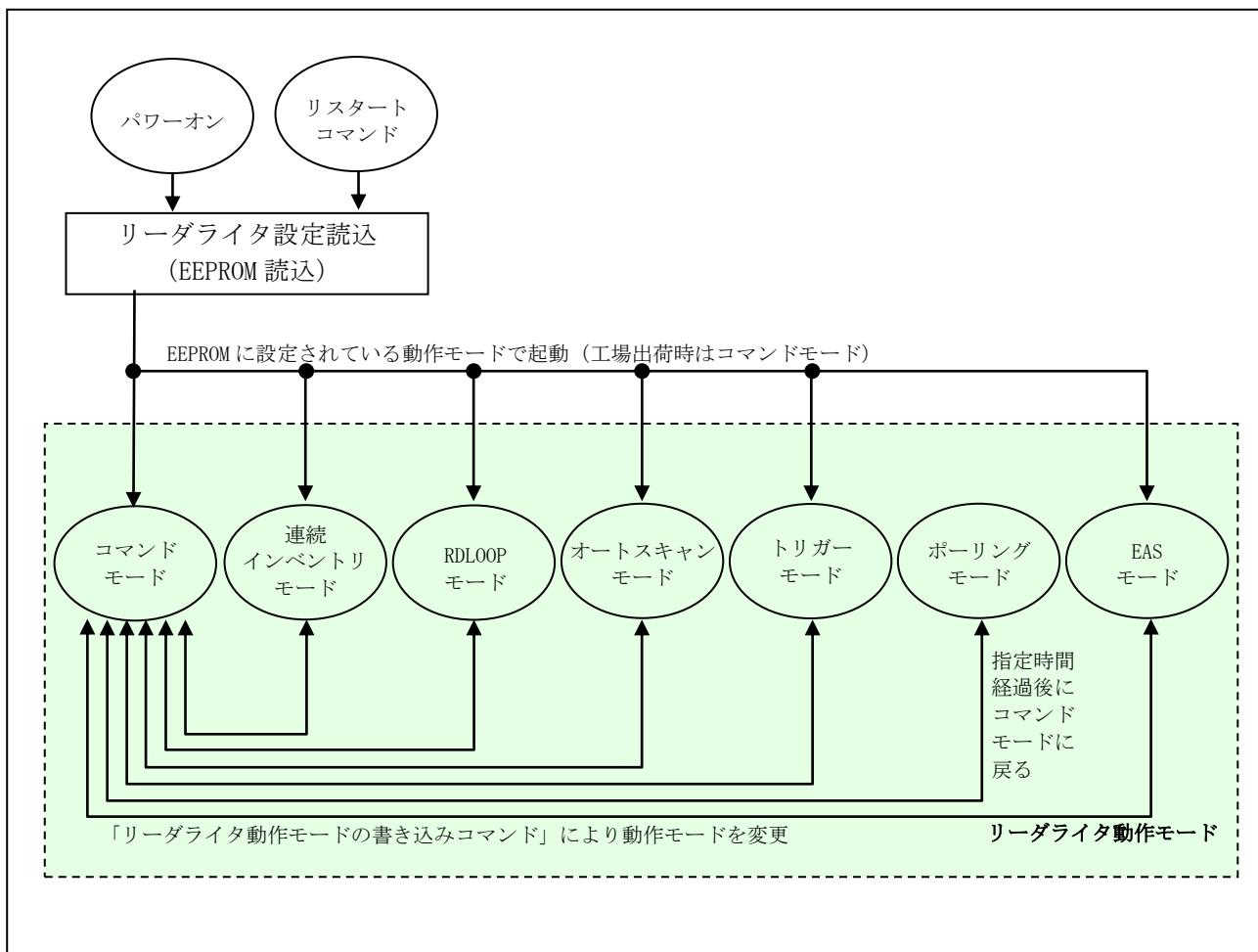
リーダライタは、電源起動後、およびリスタートコマンド受信後にリーダライタ内部に設定されている動作モード（EEPROM 設定）を読み取り、そのモードで起動します。工場出荷時に設定されている動作モードはコマンドモードです。
