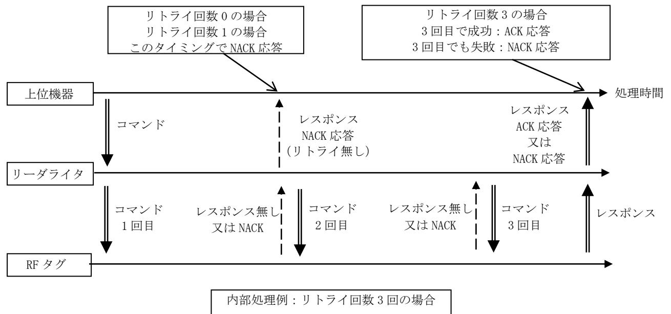
RF タグのリードコマンド、ライトコマンドを実行する際、リーダライタ内部の EEPROM にリトライ回数を設定することで、処理に失敗しても上位機器からコマンドを再送することなく、リーダライタが自動的にリトライ処理を行います。
