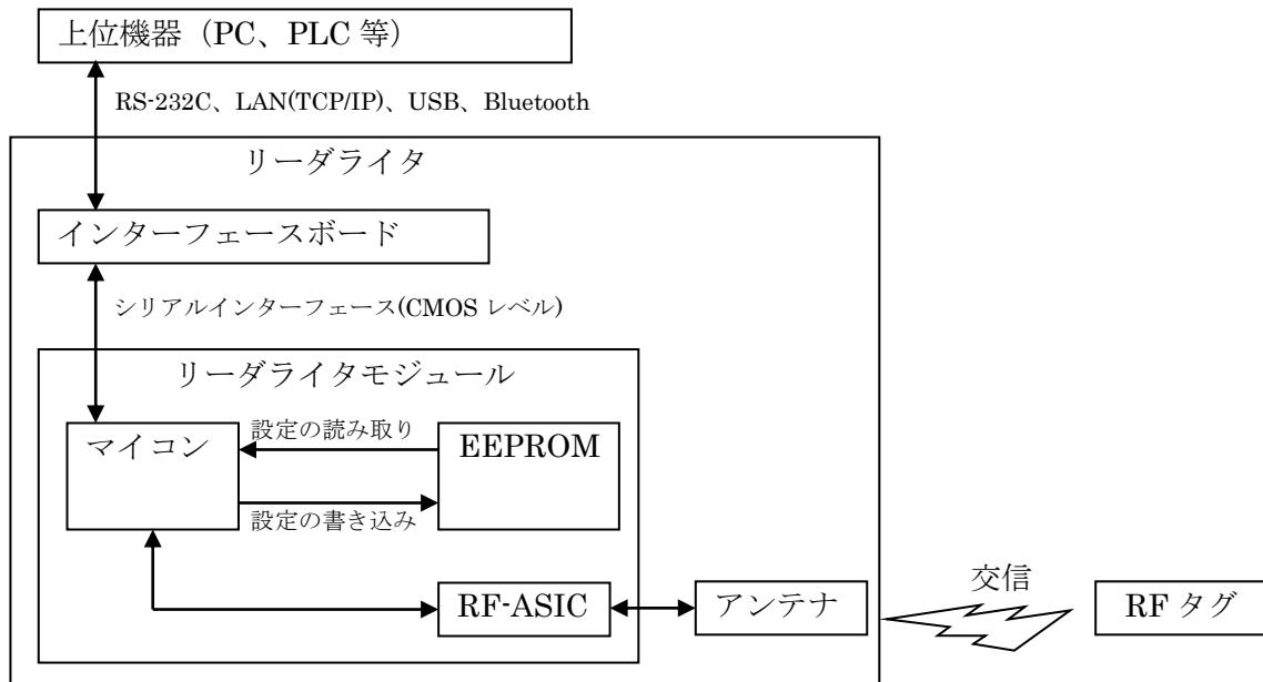
上位機器 (PC、PLC 等) とリーダライタを接続する場合、RS-232C、USB、LAN (TCP/IP)、Bluetooth のいずれかのインターフェースで通信を行います。
