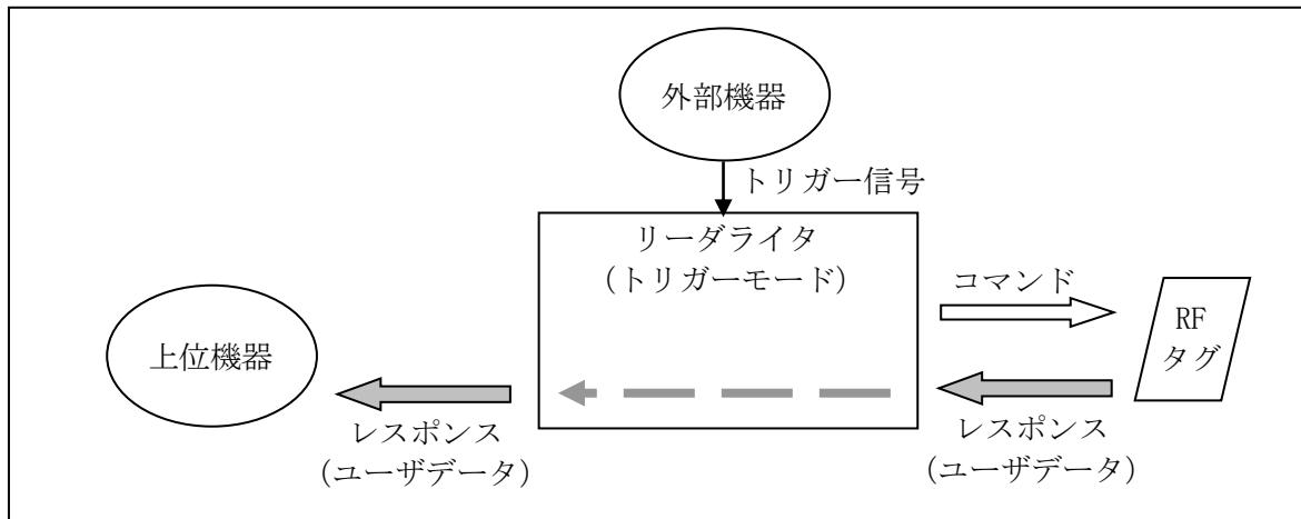
リーダライタに入力されたトリガー信号が有効な間だけ、SimpleWrite で書き込まれた TR3 シリーズ独自フォーマットのデータを、上位機器とは非同期で繰り返し読み取るモードです。本モードは、ISO15693 準拠の RF タグのみサポートしています。
