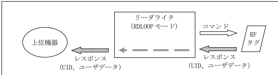
RF タグの UID (ISO15693 準拠の RF タグのみ) と指定したユーザエリアのデータを、上位機器とは非同期で繰り返し読み取るモードです。
