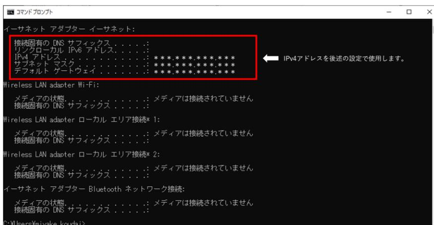
(2) 確認した PC の IP アドレスをもとに、「TR3IFBTool」を使用し、以下の手順で、本製品の IP アドレス、サブネットマスクを通信可能な状態に設定します。
