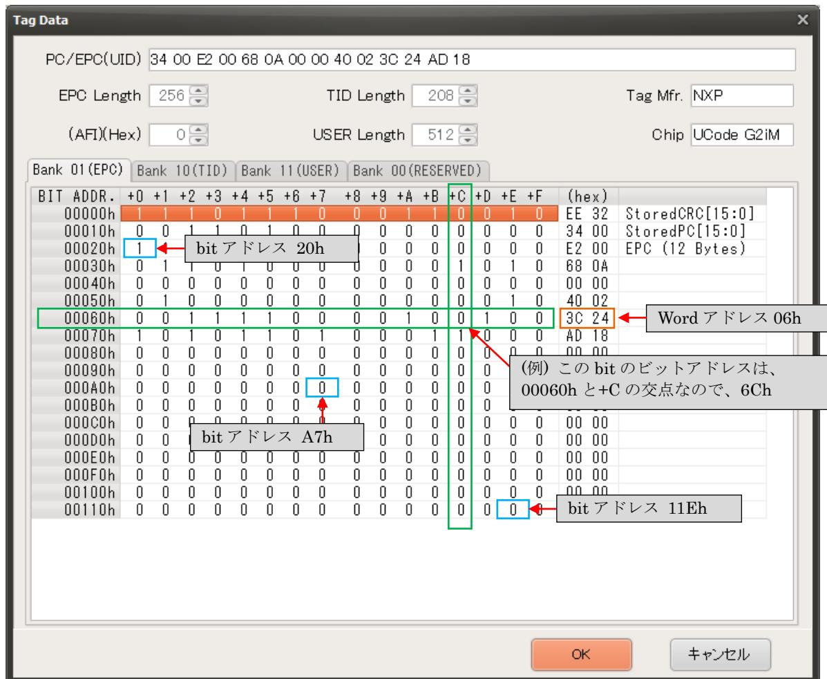
RF タグ内の全ての内容を取得して、EPC や RF タグの製造メーカー RF タグの種類などの情報を画面に表示します。
