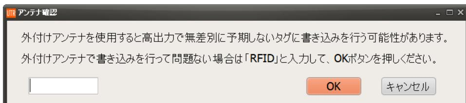
外付けアンテナに高利得のアンテナを接続した場合、リーダライタおよびアンテナから離れた位置にある RF タグに書き込みを行う可能性がありますので、リスクを理解した上でご使用ください。
