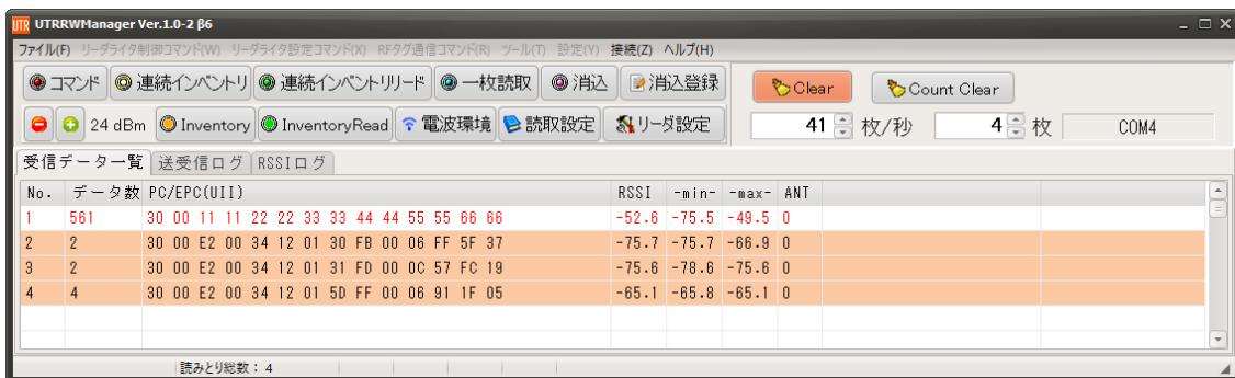
[連続インベントリモード]や[連続インベントリモード]などの「自動読み取りモード」に設定し、RF タグをアンテナにかざすと、RSSI 値のログが表示されます。
