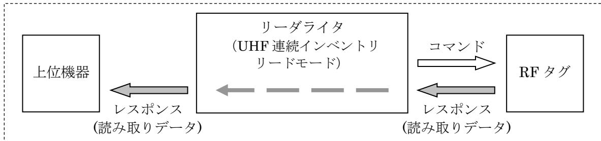
画面 1 の③赤枠内の「連続インベントリリード」ボタンを押すと、「UHF 連続インベントリリードモード」に切り替わります。「UHF 連続インベントリリードモード」では、上位アプリケーションからのコマンド指示を受けることなく、リーダライタが自動的に RF タグの EPC(UII)と指定したエリアのデータを読み取り、リーダライタから上位機器にデータを送信します。
