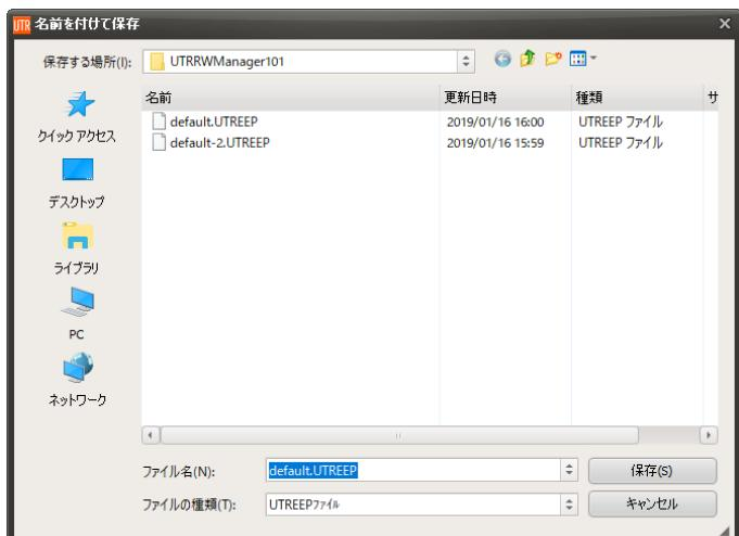
保存した FLASH データの内容は、「3.7.4 リーダライタの FLASH 設定をファイルから復元」メニューで読み込むことで、1 台のリーダライタに設定した FLASH データの内容を複数のリーダライタに複製したり、リーダライタの FLASH データの内容を特定のデータに一括で変更したりする際に使用します。
