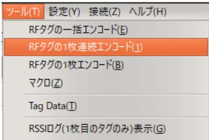
「RF タグの 1 枚連続エンコード」は、アンテナの交信エリア内に入った RF タグの内容を、無条件に自動的に書き換えます。
