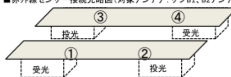
■赤外線センサー接続先略図(対象アンテナ:サブB1、B2アンテナ)
